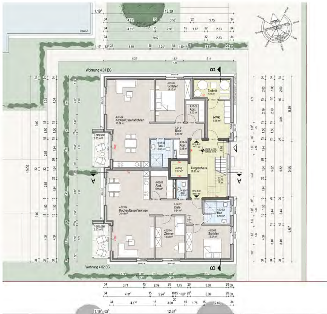
HAUS 4 Grundriss Erdgeschoss
